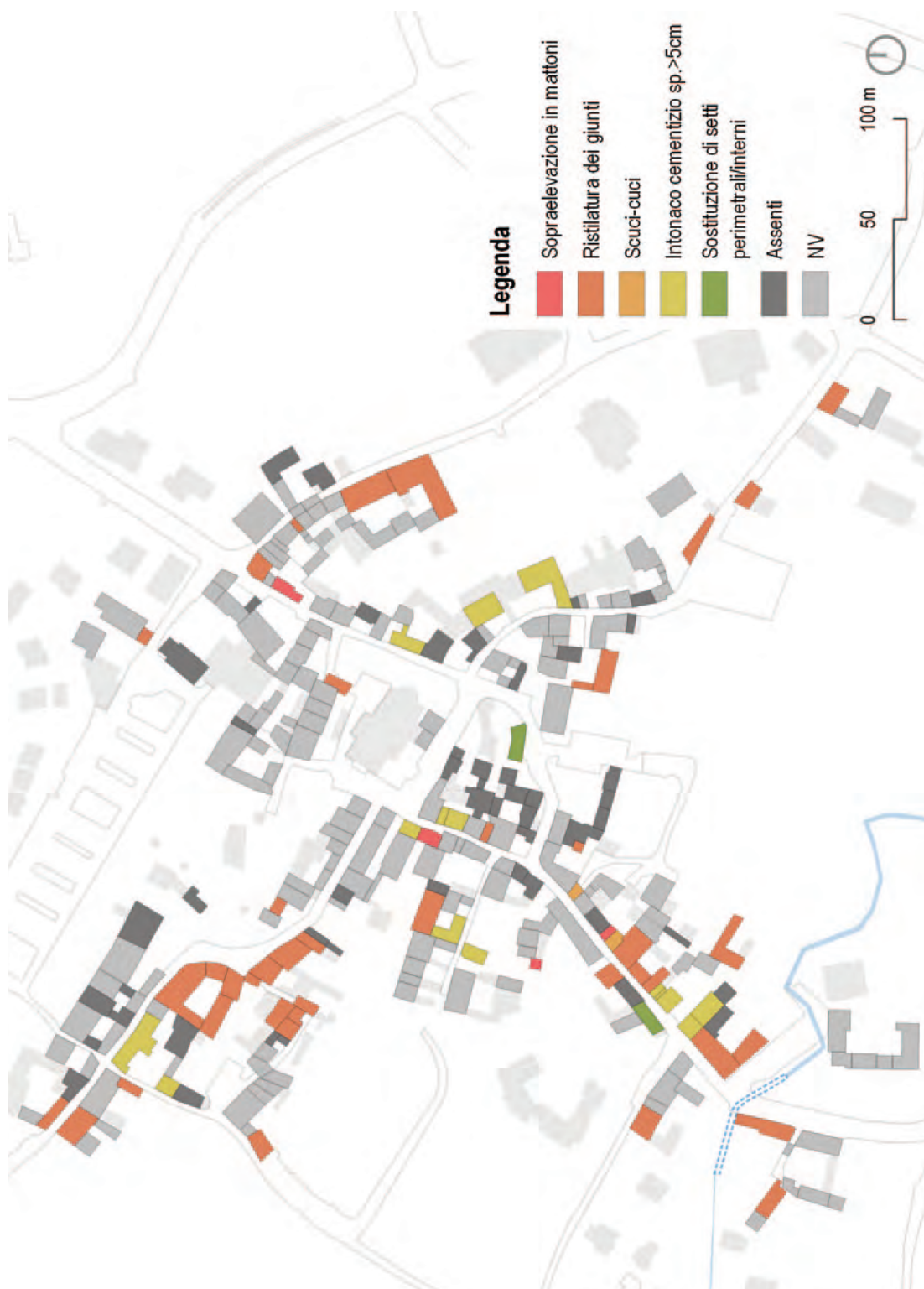
Fig. 37. Individuazione dei tipi di interventi strutturali riconosciuti a vista nelle murature degli edifici; gli edifici non valutabili (NV) sono indicati in grigio chiaro.
