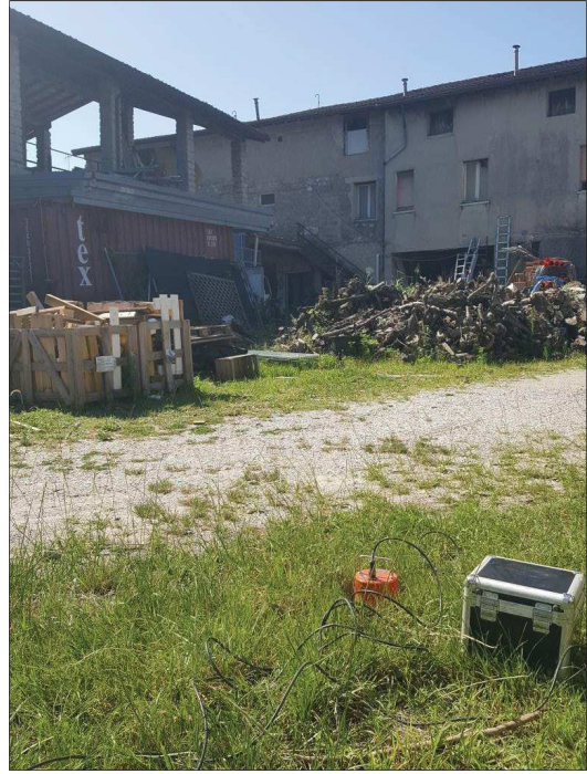
Misura del microtremore sismico mediante tecnica H.V.S.R.
