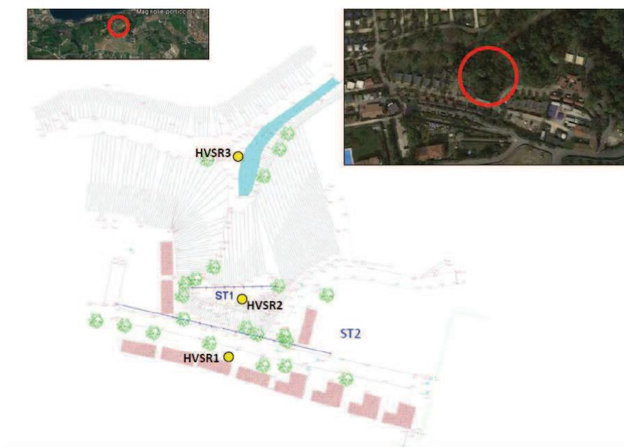
Figura-5\_ Estratto indagine sismica con posizione delle 2 linee di stesa e delle 3 indagini HVSR
